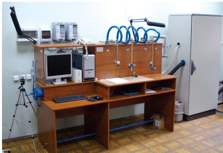
Рис.2. Установка для поверки счетчиков газа – ПУ-65.
