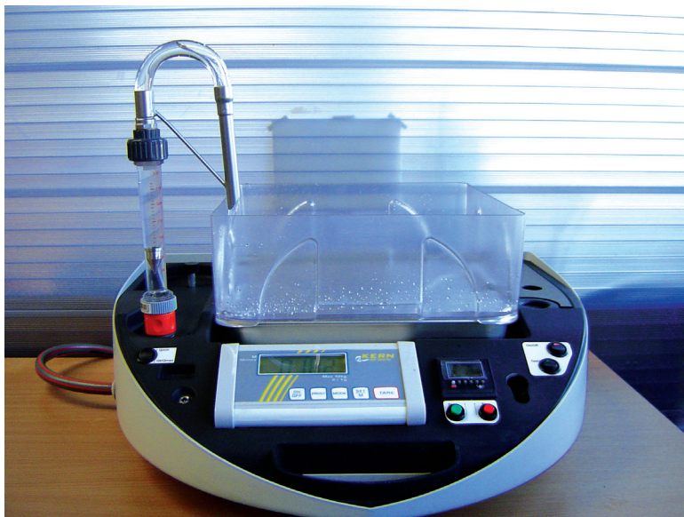
Рис.1. Установка переносная поверочная «Водоучет-2М».
