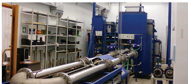
Фото 1. Поверочная расходомерная установка ВПУ-05 со дним рабочим столом (г.Альметьевск)
