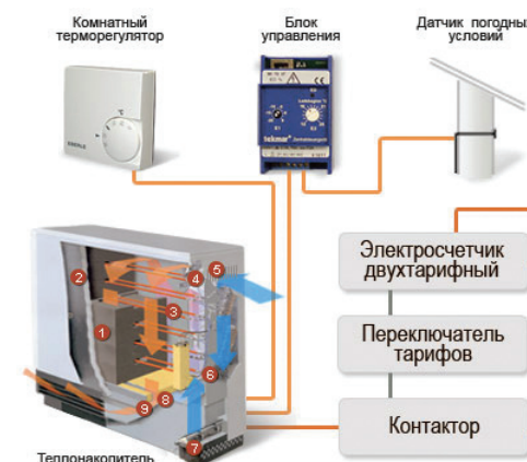
Принципиальная схема работы теплогенерирующего отопительного прибора
