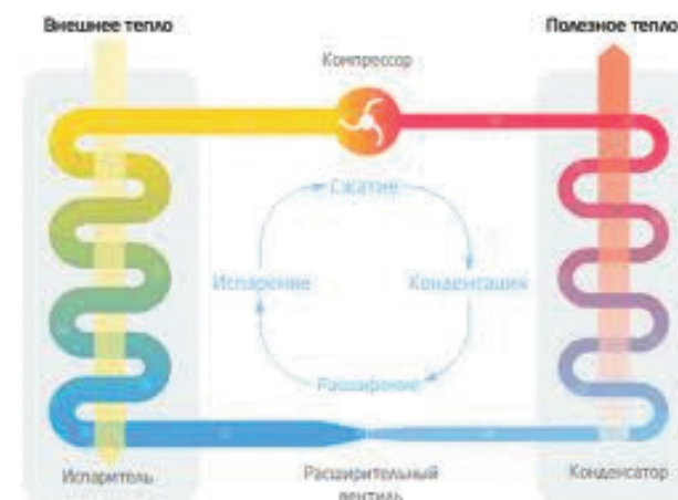
Принцип работы рекуперационной системы с тепловым насосом
